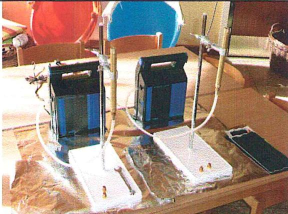
Im Gruppenraum 3 zeigt sich ein deutlicher Holzschutzmittelgeruch (Naphthalin). Ab ca. 10:00 hat der Geruch sich weiter verstärkt. Die Ursache lag in der verstärkten Sonneneinstrahlung. Sie hat den Dachaufbau erwärmt. Bild links: Probenahme der Raumluft auf leichtflüchtige Schadstoffe mit automatischen Pumpen.
